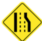
Fin de la voie de droite
