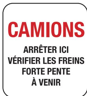
Dans certaines régions, des panneaux indicateurs sont placés avant les descentes longues ou abruptes. Ils indiquent que le conducteur doit arrêter le véhicule sur l'aire de stationnement et inspecter le système de freinage avant de poursuivre sa route. Vérifiez ce qui suit :
