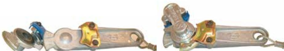
Si le véhicule n'est pas équipé de porte-têtes d'accouplement (fausses têtes), la tête d'accouplement de la conduite de commande (freins de service) peut être raccordée à la tête d'accouplement de la conduite d'alimentation (freins de secours) pour éviter l'infiltration d'eau et de terre dans les conduites non utilisées. Plus l'alimentation en air est propre, moins il y a de risques d'avoir des problèmes de frein.
